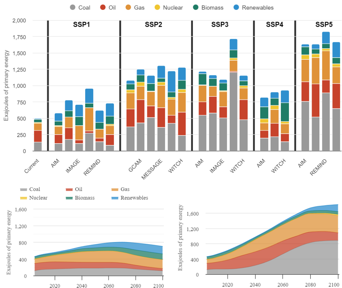
Figuur 4: Bovenfiguur: Mondiaal primair energieverbruik per brandstoftype in 2100 in exajoule (EJ) voor de vijf SSP-basisscenario's volgens enkele modellen. Het huidige energieverbruik (vanaf 2010) wordt ter referentie weergegeven links in de figuur (bron figuur: Carbon Brief). Onderfiguren: Tijdsevolutie in dit mondiaal primair energieverbruik per brandstoftype voor SSP1 (linkeronderfiguur) en SSP5 (rechteronderfiguur) voor een voorbeeldmodel.
