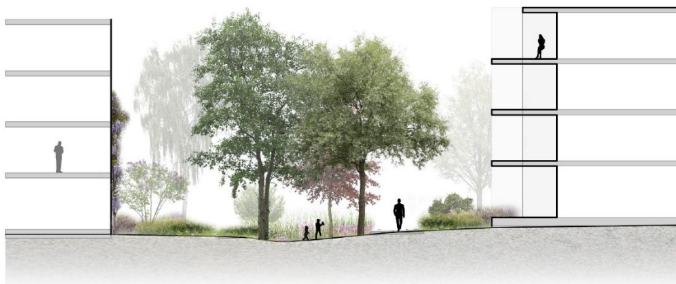
Infiltratiekom in de Gilen Real Estate wijk van Studio BNL
